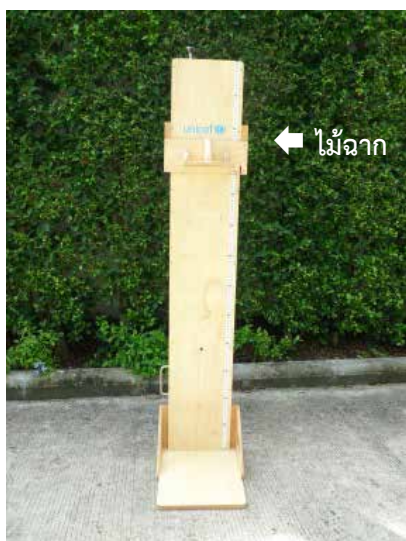
เครื่องวัดส่วนสูง เลือกที่มีความละเอียด 0.1 เซนติเมตร
